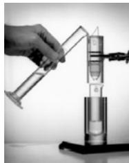
$^{99\text{m}}\text{TcO}_4^-$ は種々の化学形に容易に変換できる長所。我が国は $^{99}\text{Mo}(\beta, \gamma)$ ( $\tau_{1/2}=66\text{h}$ )を毎日輸入。生理食塩水でMoから溶離(カウミルキングによるアイソトープジェネレータ)。
