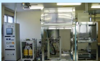
模擬デブリ作製用電気炉
