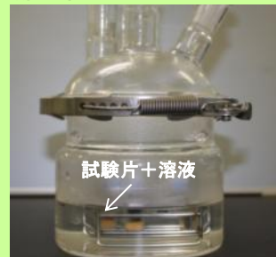
材料浸漬試験(EDF-3)
