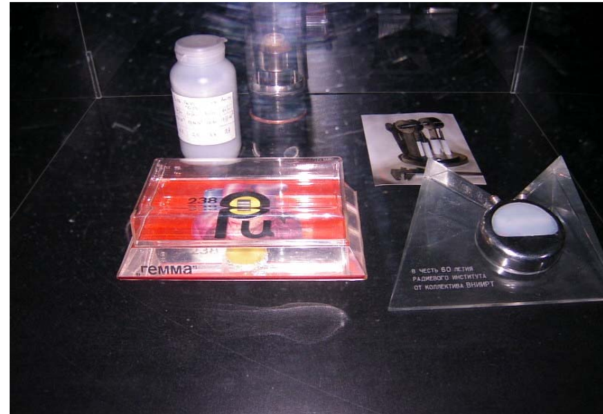
^{238}\text{Pu} pacemaker (KRI) ca.150mgPuO 2 ^{241}\text{Am}(n, \gamma)^{242}\text{Am}(\beta^-) \rightarrow ^{242}\text{Cm}(\alpha) \rightarrow ^{238}\text{Pu}
