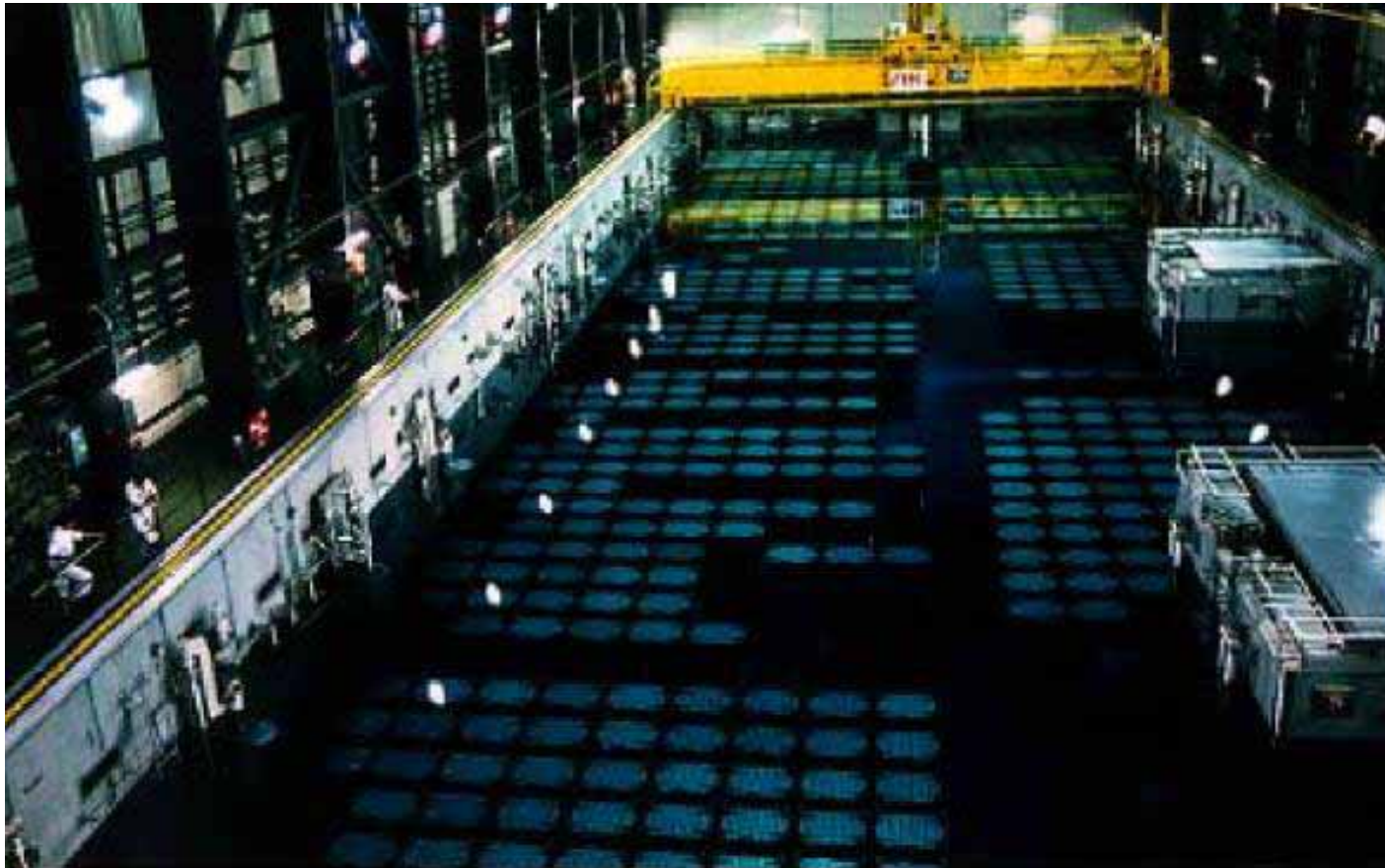
写真3-1 La HagueとUP-3の使用済み燃料冷却プール（COGEMA情報より）
